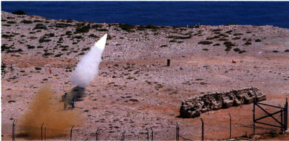
Photo 3 - Allumage du moteur d'accélération avec la fumée au démarrage
