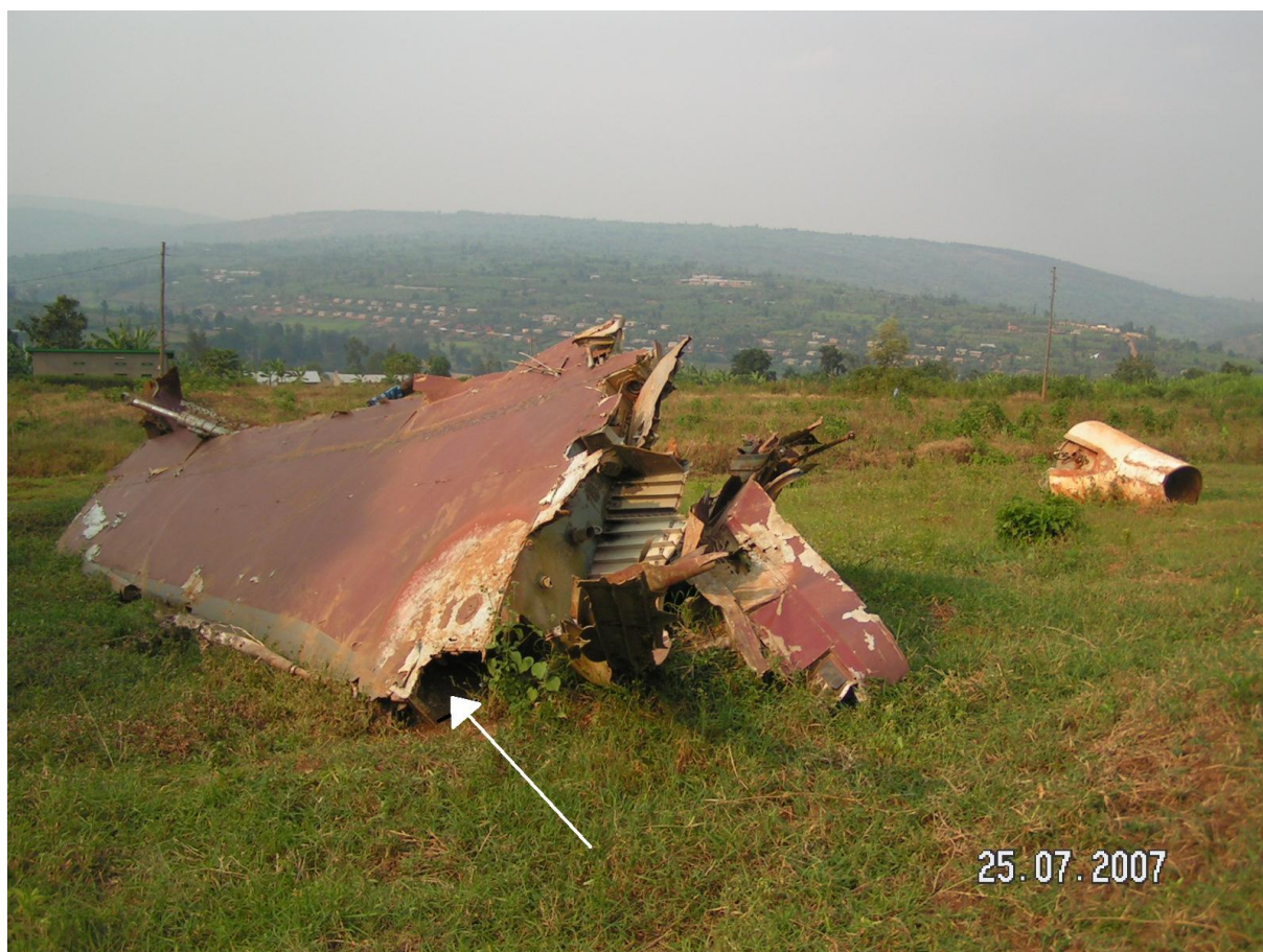
FIGURE 7.11 – Aile droite du Falcon 50. Le trou est visible dans le coin inférieur droit avec l'auréole blanche due au feu (indiqué par une flèche). Les volets sur le bord de fuite prouvent qu'il s'agit du dessus de l'aile droite et que le trou échancre le bord d'attaque. Photo de Pierre Jamagne, 25 juillet 2007, Kanombe.
