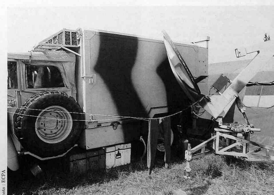
Le matériel de transmission nécessite des shelters spécialisés et tropicalisés.
